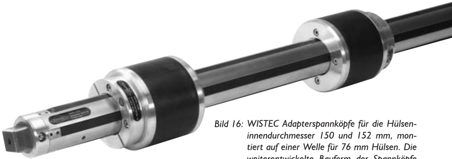
*Bild 16: WISTEC Adapterspannköpfe für die Hülseninnendurchmesser 150 und 152 mm, montiert auf einer Welle für 76 mm Hülsen. Die weiterentwickelte Bauform der Spannköpfe ermöglicht eine um 15% höhere Drehmomentübertragung.*
