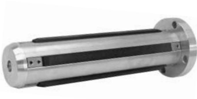
Bild 6: Spannweite, Flanschausführung, für 76 mm Hülsen mit 5 Spannleisten am Umfang
