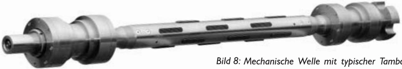
*Bild 8: Mechanische Welle mit typischer Tambourlagerung, ausgelegt für eine Bahngeschwindigkeit von 2500 m min<sup>-1</sup>; Keilreihen ohne Zwischenräume angeordnet*
